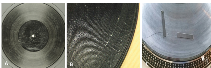
Figure 6 - A) apparition de la couche interne en coton ©BnF, B) disque cassé et reconstitué ©, C) usure prononcée du sillon © C. Bergeat.
